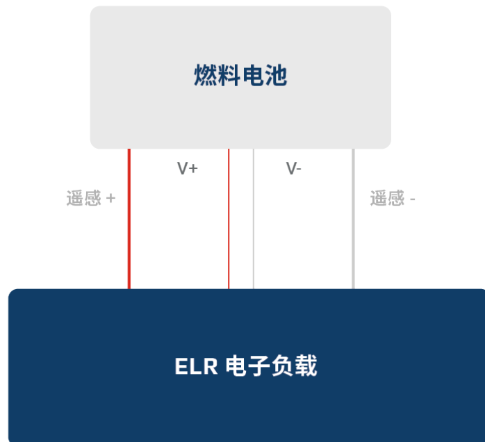
图 4 使用电流中断法测量燃料电池电阻的测试设置
